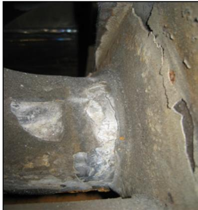
Ausgeprägte Härtebelagsbildung am Abgaseintritt eines Abgaswärmetauschers durch unzureichend enthärtetes Füll- und Ergänzungswasser
