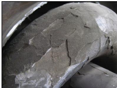
Härtebelagsbildung auf den Wärmeübertragungsflächen eines Abgaswärmetauschers
