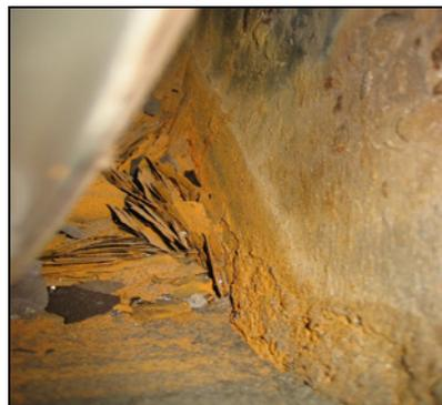
Korrosion im gesamten Rohrleitungsnetz der Warmwasser-Heizungsanlage durch zu niedrigen pH-Wert des Heizwassers. Die Rostpartikel setzen sich vorzugsweise an Orten mit nur geringer Strömungsgeschwindigkeit ab.
