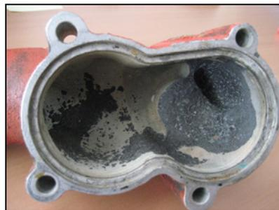
Starke Korrosion an einem Thermostatgehäuse aus Aluminium infolge eines zu hohen pH-Wertes und zu geringer Frostschutzmittelkonzentration
